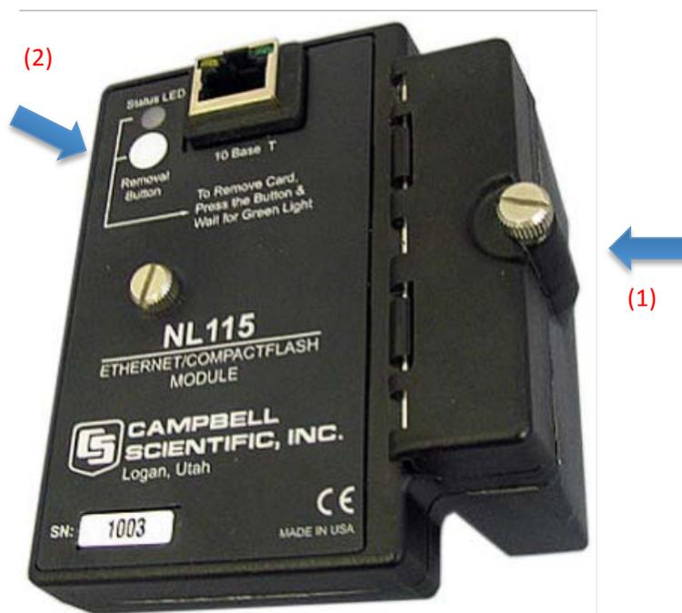
A primeira etapa é abrir a tampa lateral (1) da interface NL115 acoplada ao datalogger e em seguida pressionar o botão (2) chamado “Removal Button” e aguardar a “Status LED” se tornar verde.
